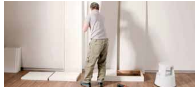
Möbelseite auf Sockel stellen. Durch die vorstehende Schraube ist das Element direkt richtig positioniert.
