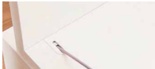
Möbelemente mit Akkuschauber und Cabineo-Werkzeug verbinden. Einfaches, schnelles Arbeiten mit voreingestelltem Drehmoment ca. 2.5 Nm.
