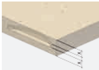
Nut mittig ausrichten
