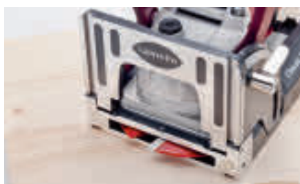
Holzreparaturen Ausflücken von Harzgallen und kleinen Rissen, HW-Fräser für Minisport Grösse 2
