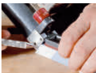
1. Fräsen und Mitte der Fräsung markieren
