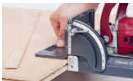
Durchgehende Nuten fräsen für Nut- und Federverbindungen, Standard HW-Nutfräser 4 mm
