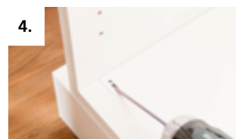
4. Assembler les éléments avec une visseuse sans fil et l'outil Cabineo. Travail simple et rapide avec un couple pré-réglé d'environ 2,5 Nm
