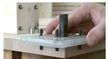
4. Platte bohren Mit der gleichen Position ohne Messen durch Anschlagen an der Kante
